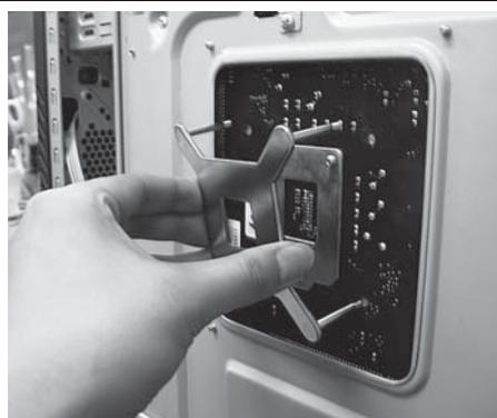
バックプレートタイプのCPUクーラーの取り付け、取り外しに際して、M/B取り付け側に穴が開いているため、PCケースからM/Bを取り外すことなくCPUクーラーの交換が可能です。
