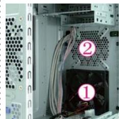
フロント側のケースファンを取付ける場合は、必ず①②の順で(下のケースファンから)取付けて下さい。
