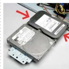
シャドウベイの下段に3.5インチHDDを取付けた場合、サイドパネルに12cmファンを取付ける事が出来なくなります。
