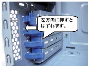
ビデオカード等を取り付ける場合、青いストッパーに記入されている矢印の左方向に押すと、ストッパーが外れます。ボードを設置後ストッパーを戻し固定します。
