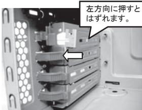
ビデオカード等を取り付ける場合、黒いストッパーに記入されている矢印の左方向に押すと、ストッパーが外れます。ボードを設置した後ストッパーを戻し固定します。
